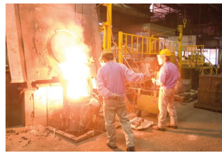
高周波電気炉で原材料を溶解する様子
