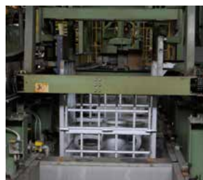
⑤酸洗 熱処理やショットブラストによる錆肌表面の酸化スケール等の汚れを取り除く。併せて、錆肌表面に保護皮膜を生成させ、耐食性をさらに高める。
