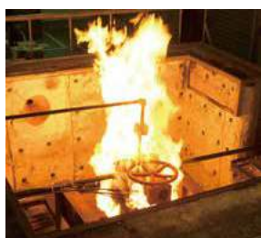
ファイアテスト バルブのシール部材が完全に焼損するほどの火災にあっても、バルブとしての機能を維持することが可能であることを確認する。
