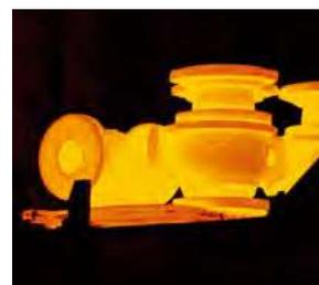
**④熱処理(固溶化熱処理)**
