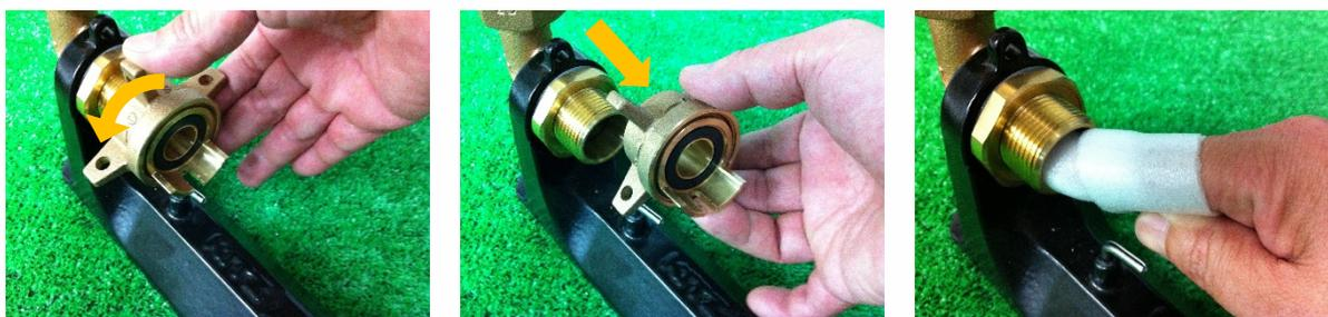
4. 取り外したスライドハンドルセットを裏返し、伸縮管に装着のOリングを、工具(裁縫用「糸きり」や「リッパー」など)を用いて取外した後のOリング溝を、竹串などを用いて清浄な布で付着物をふき取り、新しいOリングに交換してください。
