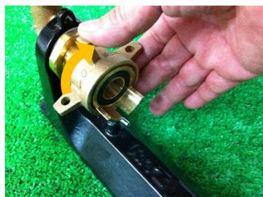
6. メータ受口溝が真下になるように伸縮管を回しておき、手順2で曲げておいたスプリングピンをプライヤーなどで曲げ戻し、メータ受口溝内に収めます。
