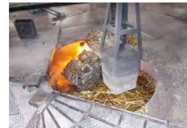
①原料配合・溶解 原材料を誘導炉で溶かす。
