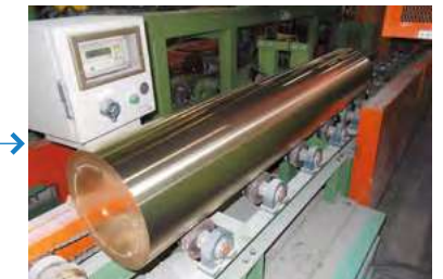
③切断 casting 塊を大型の切断機で決められた長さに切断し、押し出し用のピレット（中間製品）にする。
