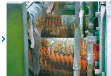
②連続 casting 水冷式横型連続 casting 機または縦型半連続 casting 機で casting 塊を casting する。
