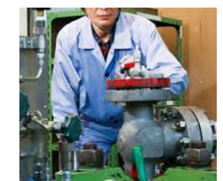
⑧圧力検査 流体を流して圧力を加え、要求品質を満たしているかを検査する。
