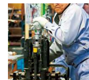
⑦組立 バルブの各部品を組み立てる。
