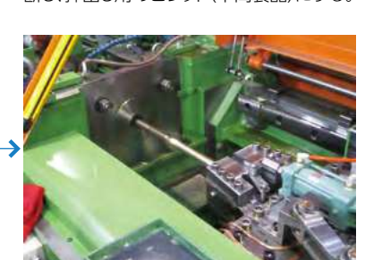
⑥冷間 drawing 直線棒・コイルを drawing 機のダイスに通し、正確な形状と寸法の棒材に仕上げる。
