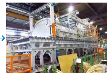
⑧低温焼鈍 棒材の残留応力の除去や硬さの調整のため、所定の温度で低温焼鈍を行う。
