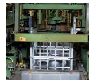
⑤酸洗 熱処理やショットブラストによる鋳肌表面の酸化スケール等の汚れを取り除く。併せて、鋳肌表面に保護皮膜を生成させ、耐食性をさらに高める。
