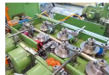
⑦矯正・切断 矯正機によって棒材の曲がりを取り除き、所定の長さに切断する。
