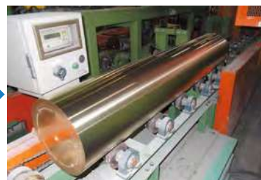
③切断 鋳塊を大型の切断機で決められた長さに切断し、押出し用のビレット(中間製品)にする。
