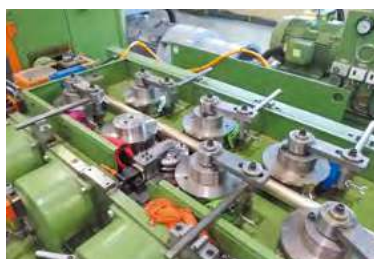
⑦矯正・切断 矯正機によって棒材の曲がりを除き、所定の長さに切断する。
