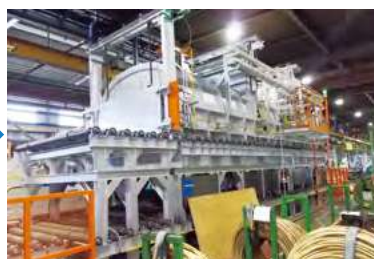
⑧低温焼鈍 棒材の残留応力の除去や硬さの調整のため、所定の温度で低温焼鈍を行う。
