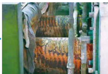
②連続鋳造 水冷式横型連続鋳造機または縦型半連続鋳造機で鋳塊を鋳造する。
