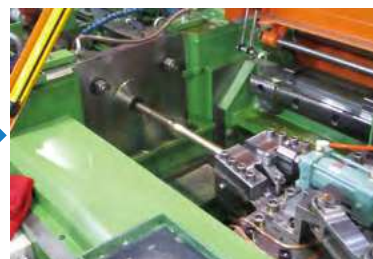
⑥冷間抽伸 直線棒・コイルを抽伸機のダイスに通し、正確な形状と寸法の棒材に仕上げる。
