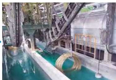
⑤連続酸洗 押出し工程で表面に付着した酸化物を、酸洗により除去する。
