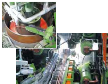
④加熱・押出し ビレットを所定の温度まで加熱。押出機により、直線棒またはコイル状に押し出す。
