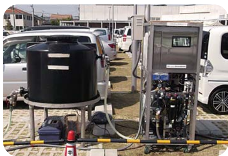
被災地に設置された「アクアレスキュー」。沢の水から河川水、井戸水などさまざまな原水に対応する、可搬式でオールインワンの高性能な浄水装置です。
