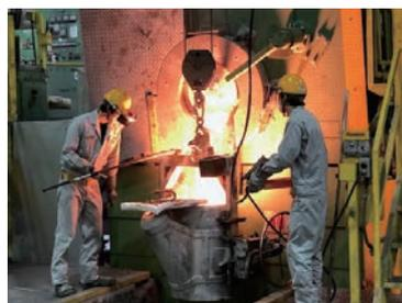
2020年8月、長坂工場に溶解重量500kgの高周波誘導炉を導入しました。従来、特殊材料鋳物の製造は、溶解重量1tの高周波炉で行っていますが、新たに500kgの設備を導入することにより、少量の特殊材料鋳物にも対応できるようになるとともに、リードタイム短縮の効果による短納期を実現することができます。また、炉体の小型化によるランニングコストの低減や直行率\*の向上も期待できます。
