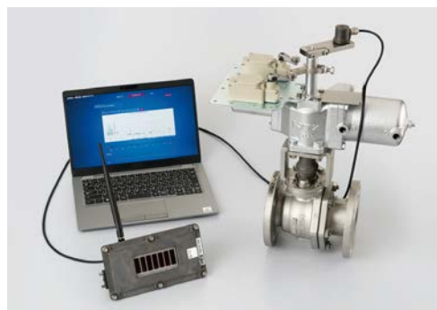
センサ等の機器を搭載したバルブ
