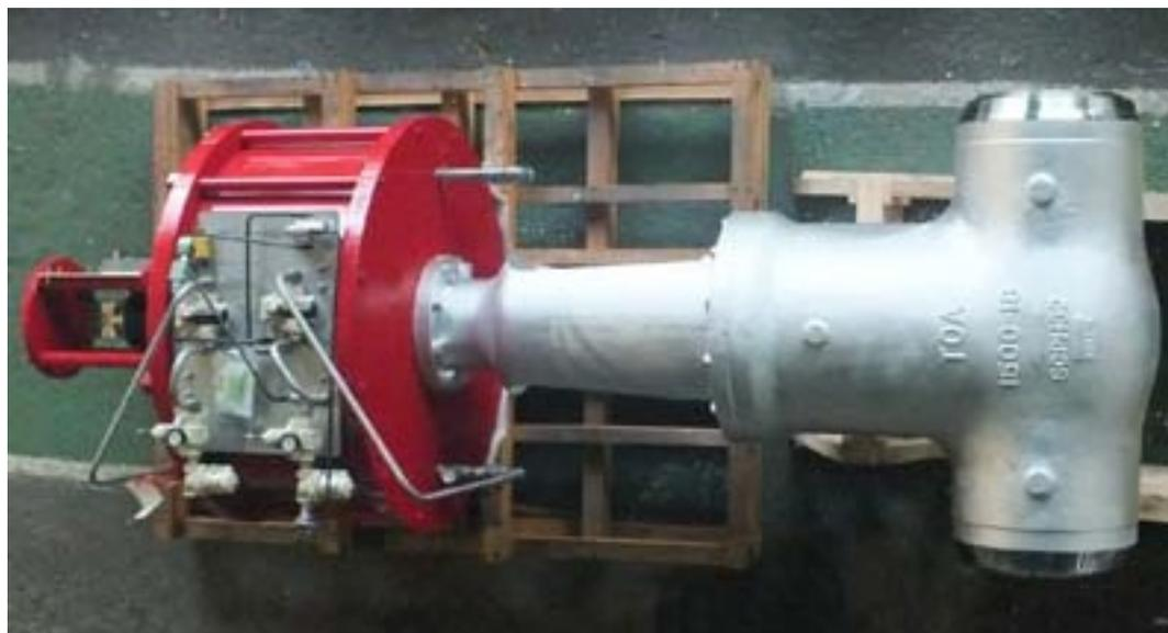
YKV製の縦型シリンダーを搭載したTVE製ゲートバルブ
