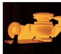
**④熱処理(固溶化熱処理)**
