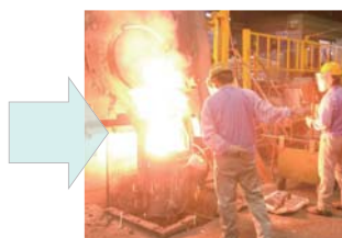
①溶解 原材料を高周波電気炉で溶かします。
