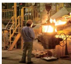
②受湯 溶湯を取鋼に入れます。
