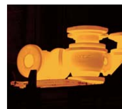
④熱処理(固溶化熱処理) 素材を1,100℃まで加熱した後、急冷(水冷)します。これにより、均一な金属組織を得ることができ、引っ張り、伸びなどの機械的性質(強度)を高めます。
