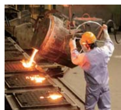
③注湯 鋳型に溶湯を流し込みます。上と下の型と中子のすき間に溶湯が流れ込みます。
