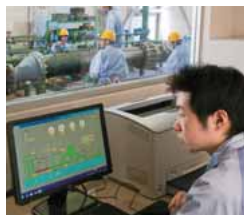
流量試験 配管を再現してバルブを設置し、流体を流すことにより得られる圧力の差を測定します。測定した値は、お客様のプラント設計に反映されています。
