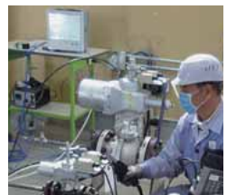
ローエミッションテスト 国内では、唯一、API規格に基づくメタンガスによる試験設備を自社で保有し、実際の流体を使用した漏れ試験による実証を行っています。
