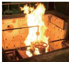
ファイアテスト バルブのシール部材が完全に焼損するほどの火災にあっても、バルブとしての機能を維持することが可能であることを確認しています。
