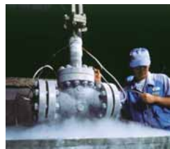
低温試験 LNG(液化天然ガス)は低温の流体であることから、低温状態を再現して試験を行います。
