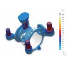
③ 鋳造解析 凝固解析により鋳造に最適な型の方案設計を行います。
