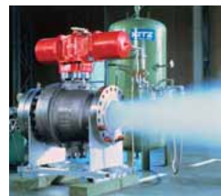
ブローオフ試験 高温・高圧の流体制御では、バルブの開閉時に大きな力が加わります。使用限界条件下におけるバルブの正確な作動を確認しています。
