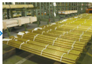
⑨計量・梱包・出荷 完成した棒材を、所定の重量または本数で結束・梱包し配送する。
