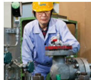
⑧圧力検査 流体を流して圧力を加え、要求品質を満たしているかを検査する。
