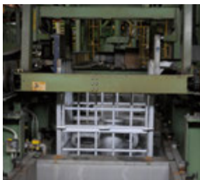
⑤酸洗 熱処理やショットブラストによる鑄肌表面の酸化スケールなどの汚れを取り除く。併せて、鑄肌表面に保護皮膜を生成させ、耐食性をさらに高める。
