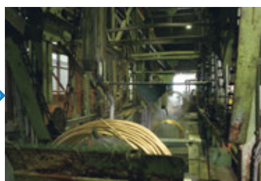
⑤連続酸洗 押し出し工程で表面に付着した酸化物を、酸洗いにより除去する。
