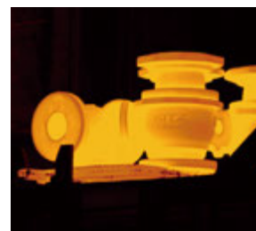
④熱処理(固溶熱処理) 素材を1,100℃まで加熱した後、急冷(水冷)。これにより、均一な金属組織が得られ、引っ張り、伸びなどの機械的性質(強度)を高めるとともに、耐食性を確保できる。
