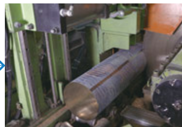
③切断 鋳塊を大型の切断機で決められた長さに切断し、押し出し用のピレット(中間製品)にする。
