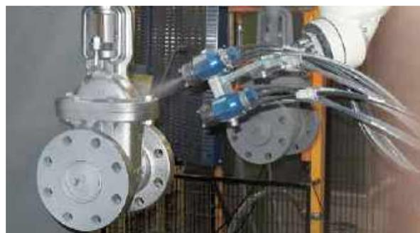
伊那工場に導入している塗装ロボット
