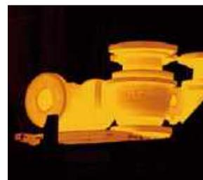
**④熱処理(固溶熱処理)**
