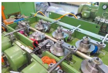
⑦矯正・切断 矯正機によって棒材の曲がりを除き、所定の長さに切断する。
