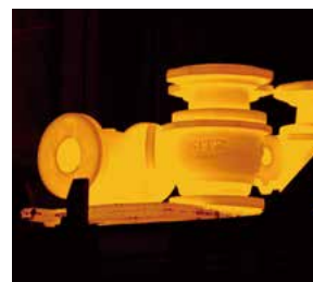
④熱処理(固溶化熱処理) 素材を1,100℃まで加熱した後、急冷(水冷)。これにより、均一な金属組織が得られ、引っ張り、伸びなどの機械的性質(強度)を高めるとともに、耐食性を確保できる。
