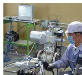
ローエミッションテスト 国内では、唯一、API規格に基づくメタンガスによる試験設備を自社で保有。実際の流体を使用した漏れ試験を行う。
