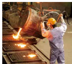
③注湯 鋳型に溶湯を流し込む。上と下の型と中子のすき間に溶湯が流れ込む。
