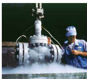
低温試験 LNGは低温の流体のため、低温状態を再現して試験を行う。
