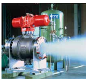
ブローオフ試験 高温・高圧の流体制御では、バルブの開閉時に大きな力が加わるため、使用限界条件下でのバルブの正確な作動を確認する。
