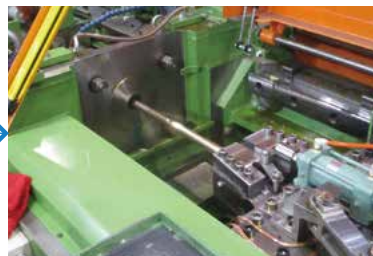
⑥冷間抽伸 直線棒・コイルを抽伸機のダイスに通し、正確な形状と寸法の棒材に仕上げる。
