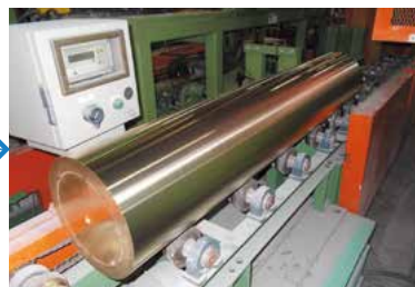
③切断 鋳塊を大型の切断機で決められた長さに切断し、押し出し用のビレット(中間製品)にする。
