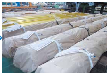
⑨計量・梱包・出荷 完成した棒材を、所定の重量または本数で結束・梱包し配送する。
