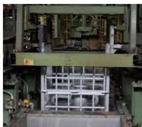
⑤酸洗 熱処理やショットブラストによる鋳肌表面の酸化スケールなどの汚れを取り除く。併せて、鋳肌表面に保護皮膜を生成させ、耐食性をさらに高める。
