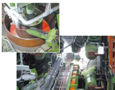
④加熱・押し出し ビレットを所定の温度まで加熱。押し出し機により、直線棒またはコイル状に押し出す。
