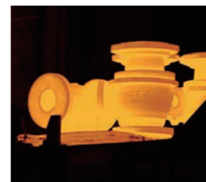
④熱処理(固溶化熱処理) 素材を1,100℃まで加熱した後、急冷(水冷)。これにより、均一な金属組織が得られ、引っ張り、伸び等の機械的性質(強度)を高めるとともに、耐食性を確保できる。
