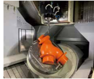
マシニングセンタを用いた鋳造型の製作
