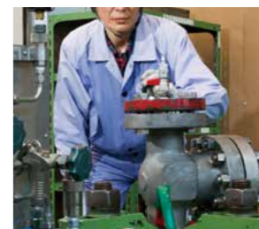
⑧圧力検査 流体を流して圧力を加え、要求品質を満たしているかを検査する。
