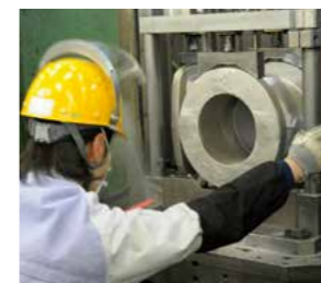
⑥機械加工 切削や穴開け等の加工を行う。
