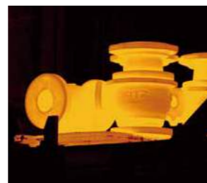
④熱処理(固溶化熱処理) 素材を1,100℃まで加熱した後、急冷(水冷)。これにより、均一な金属組織が得られ、引っ張り、伸び等の機械的性質(強度)を高めるとともに、耐食性を確保できる。
