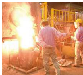
①溶解 原材料を高周波電気炉で溶かす。
