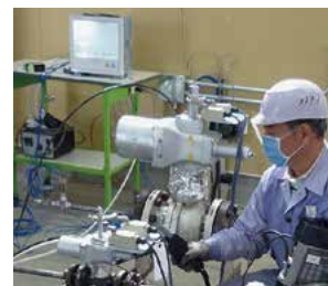
ローエミッションテスト 国内では、唯一、API規格に基づくメタンガスによる試験設備を自社で保有。実際の流体を使用した漏れ試験を行う。
