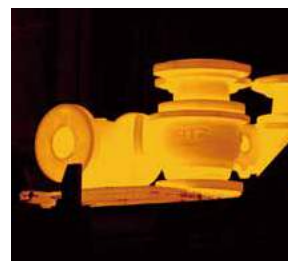
④熱処理(固溶熱処理) 素材を1,100℃まで加熱した後、急冷(水冷)。これにより、均一な金属組織が得られ、引っ張り、伸び等の機械的性質(強度)を高めるとともに、耐食性を確保できる。
