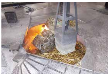
①原料配合・溶解 原材料を誘導炉で溶かす。
