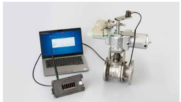
センサ等の機器を搭載したバルブ
