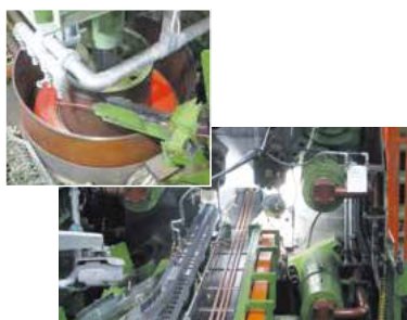
④加熱・押し出し ピレットを所定の温度まで加熱。押し出し機により、直線棒またはコイル状に押し出す。
