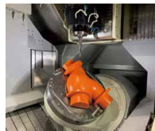
マシニングセンタを用いた鋳造型の製作
