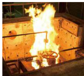
ファイアテスト バルブのシール部材が完全に焼損するほどの火災にあっても、バルブとしての機能を維持することが可能であるかを確認する。
