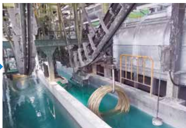
⑤連続酸洗 押し出し工程で表面に付着した酸化物を、酸洗いにより除去する。
